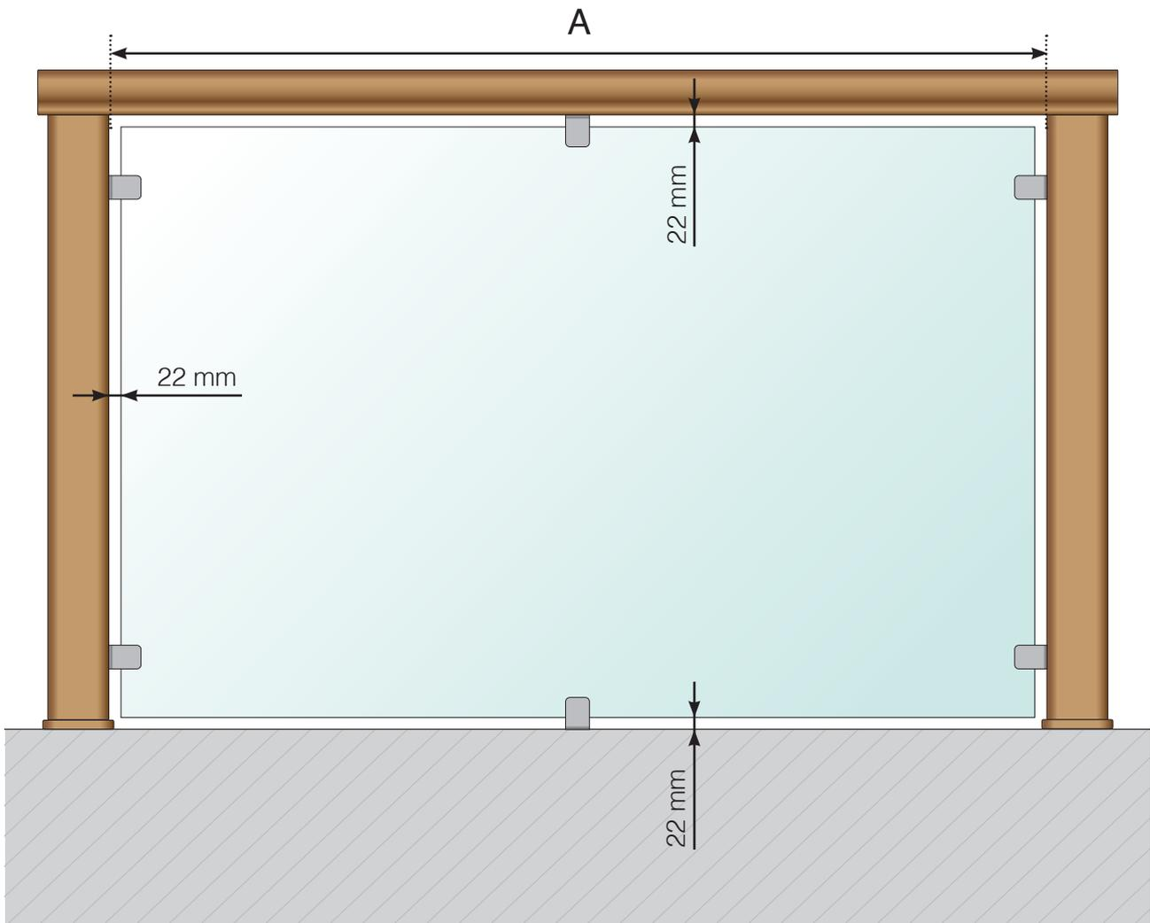
A – Wenn das Glas breiter als 1400 mm gewählt wird, werden oben und unten zusätzliche Klemmen benötigt, um die Glasplatte zu halten. Bei Maßen über 1700 mm empfehlen wir insgesamt vier Glasklemmen oben und unten. "A" ist die Breite der Öffnung und auch das im Konfigurator anzugebende Maß.
