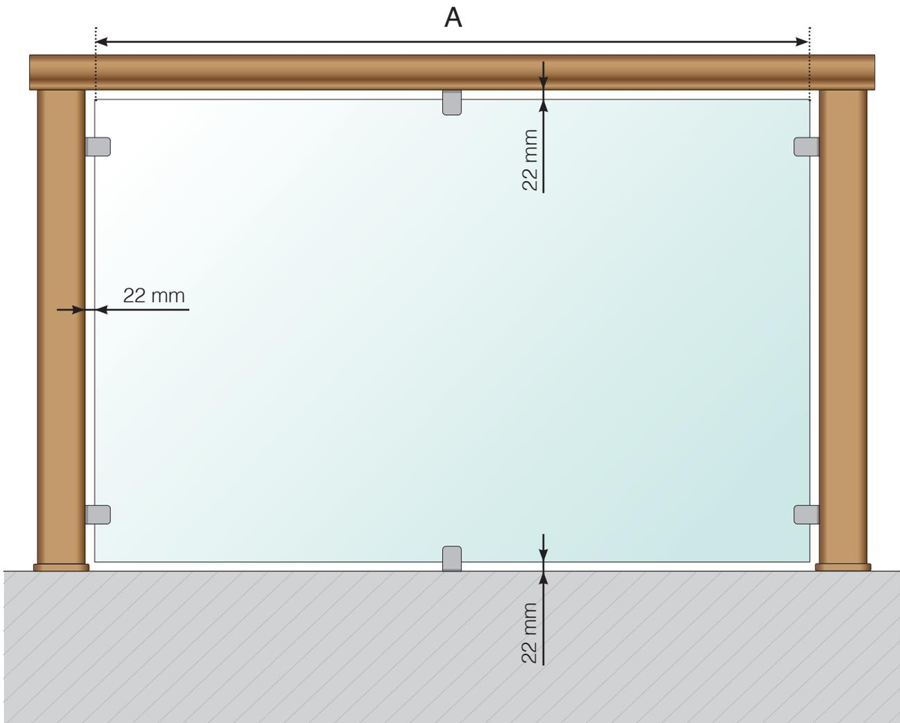
A - Wenn ein Glasabmessung breiter als 1400 mm ist, sind oben und unten zusätzliche Klemmhalter erforderlich, um die Glasplatte zu stützen. Für Glasabmessungen über 1700 mm empfehlen wir insgesamt je 4 Klemmhalter für oben und unten.
