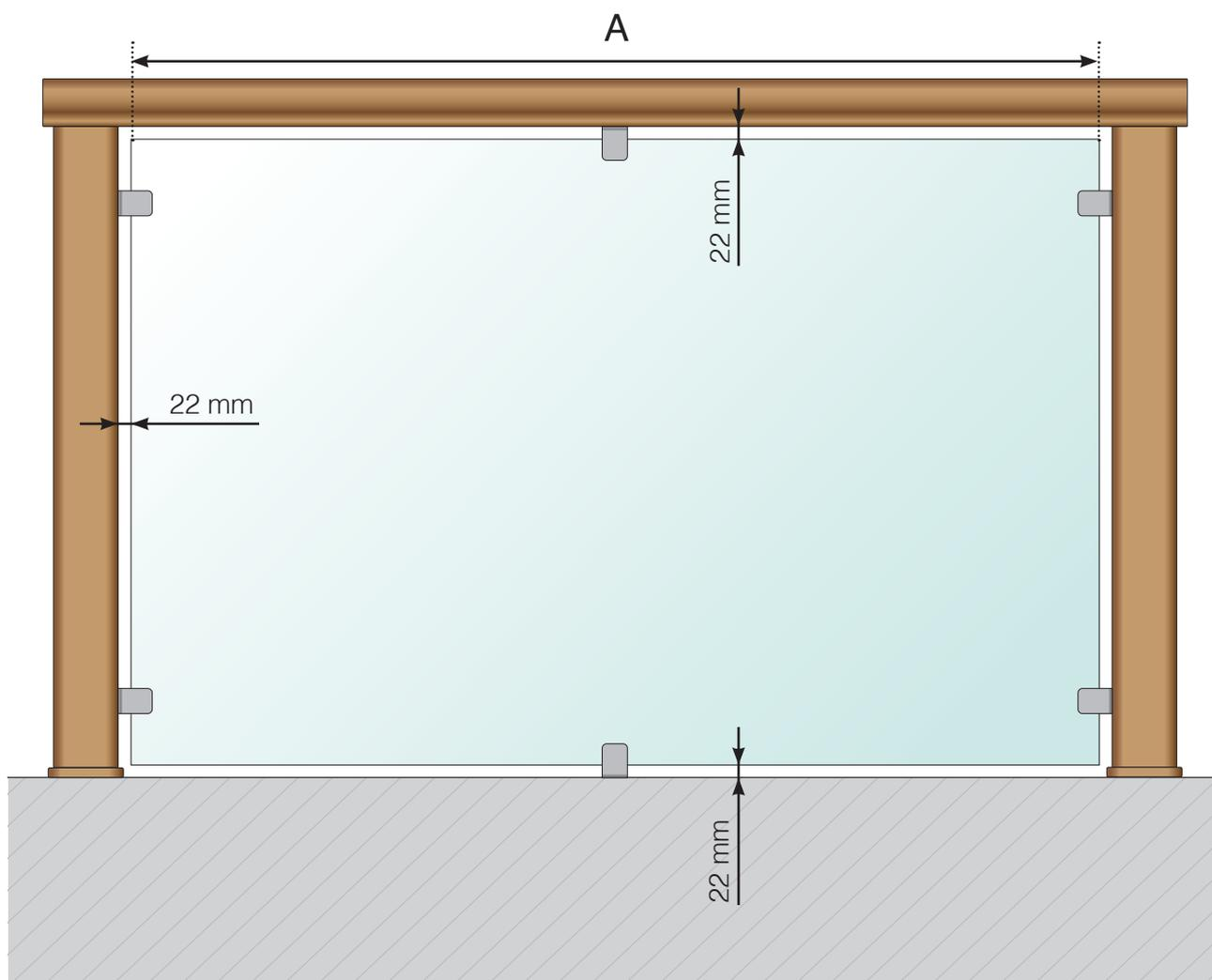
A - Lorsque le verre sélectionné a une dimension plus large que 1400 mm, des pinces à verre supplémentaires sont nécessaires en haut et en bas pour soutenir la plaque de verre. Pour des dimensions supérieures à 1700 mm, nous recommandons un total de quatre pinces à verre en haut et en bas.
